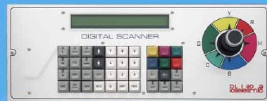
Dedicated keyboard with multifunction joystick Tastiera dedicata con joystick multifunzioni
